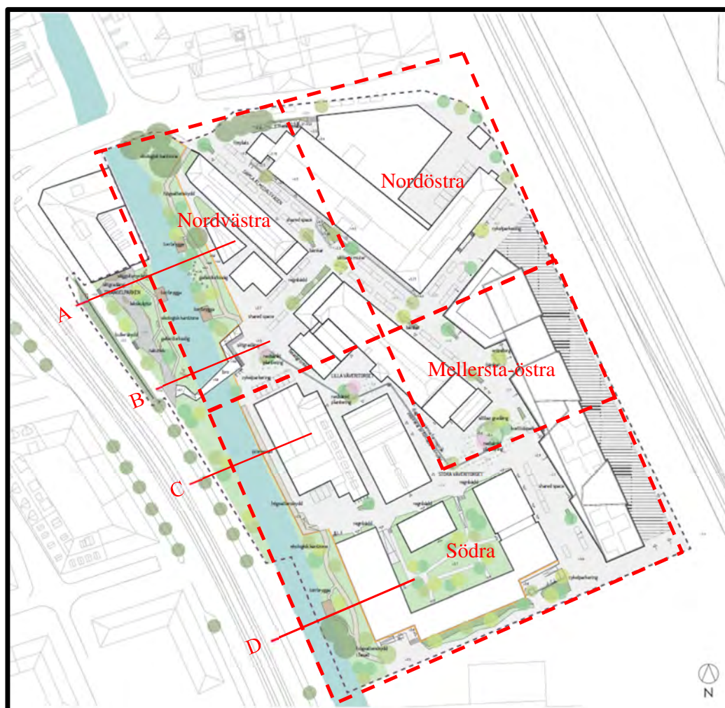
Figur 5. Gestaltning planerade förhållanden i plan med sektioner A-D för stabilitetsberäkningar.
